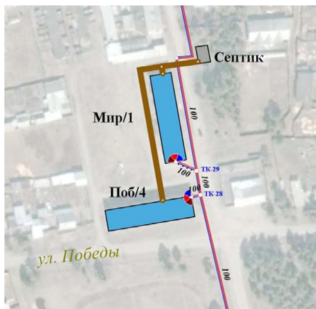
Рис. 2.1 Схема централизованного водоотведения с. Сосновка
